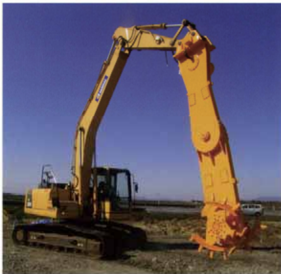
ブームランププレート装着でN値38の硬混じり砂層に対応
